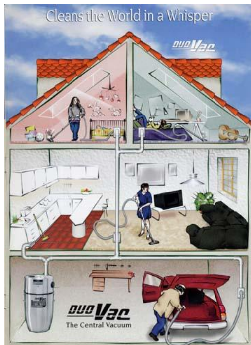
Рис. 1 – Пример монтажа трубопровода центрального пылесоса для типового 2-х этажного дома Примечание: А – силовой блок, п/р – пневморозетка, п/с – пневмосовок в цоколе кухни, п/в – пневмовыхлоп.
